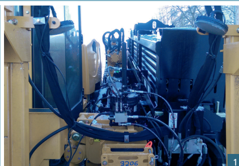
1 | Anlage zum Durchführen des Bohrspülverfahrens
